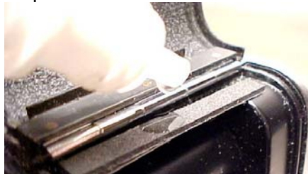
Vedante mal colocado. Aplique solvente*(veja nota). Deixe actuar e reposicione.
